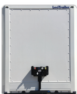
Parete anteriore: struttura monoblocco galvanizzata e in cataforesi KTL
